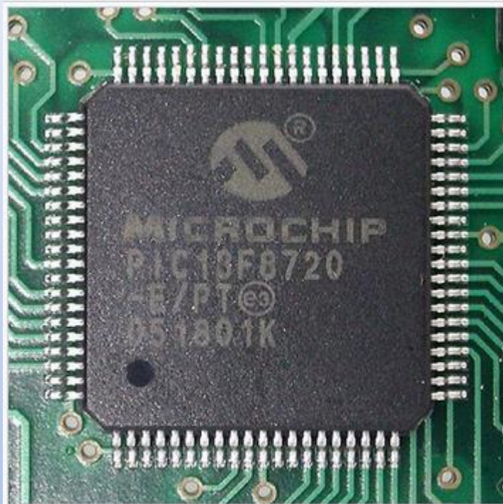
Um microcontrolador PIC18F8720 num encapsulamento TQFP de 80 pinos.
